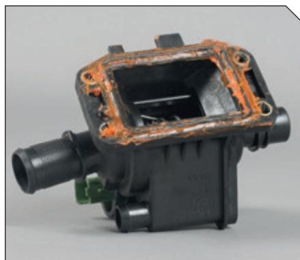
**Aspetto:** infiltrazioni, gocciolamenti o grandi segni di spurgo di refrigerante sulla superficie di montaggio o attorno a essa oppure sull'alloggiamento.
