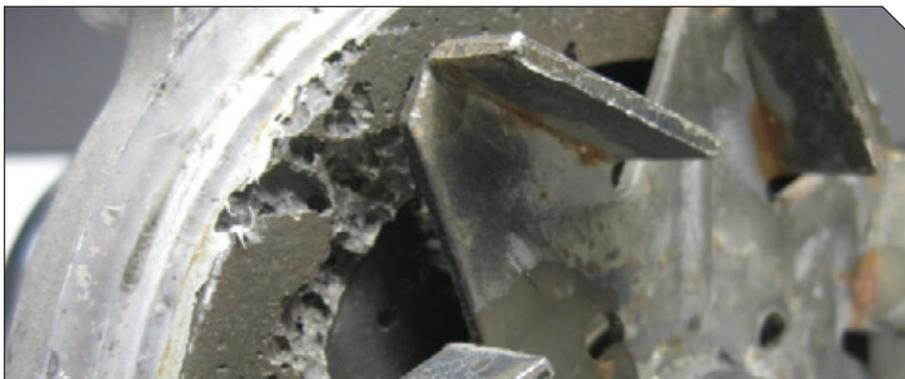
**Aspetto:** le cavità di vapore ("bolle") nel refrigerante crollano con forza esplosiva, determinando la vaiolatura dei singoli componenti della pompa. Le aree soggette a vaiolatura quindi si corrodono.
