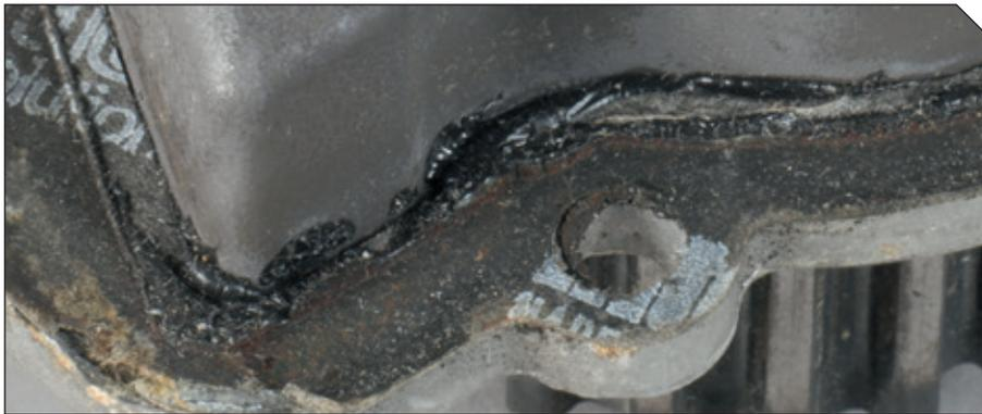
**Aspetto:** infiltrazioni, gocciolamenti o grandi segni di spurgo di refrigerante sulla superficie di montaggio o attorno a essa oppure sull'alloggiamento.
