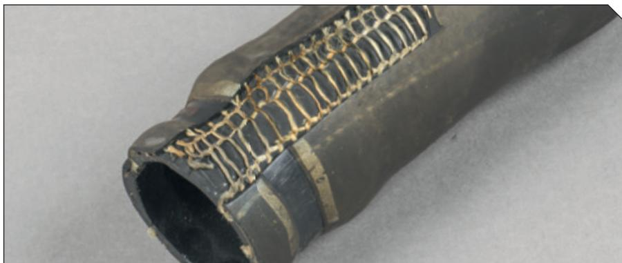
**Aspetto:** il danno da calore può verificarsi sia internamente sia esternamente. Un leggero rigonfiamento è un segno di danno interno. Se il filo interno è stato gravemente danneggiato dal calore, il tubo si presenta morbido al tatto e può persino gonfiarsi in alcuni punti. Il danno da calore esterno è più facilmente rilevabile, poiché i tubi che ne sono interessati di solito presentano una copertura indurita e lucente disseminata di crepe.
