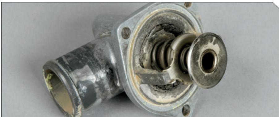
**Aspetto:** sedimenti, poltiglia e incrostazioni si accumulano all'interno, intasando il termostato e ostacolando il corretto funzionamento delle singole parti che lo compongono.
