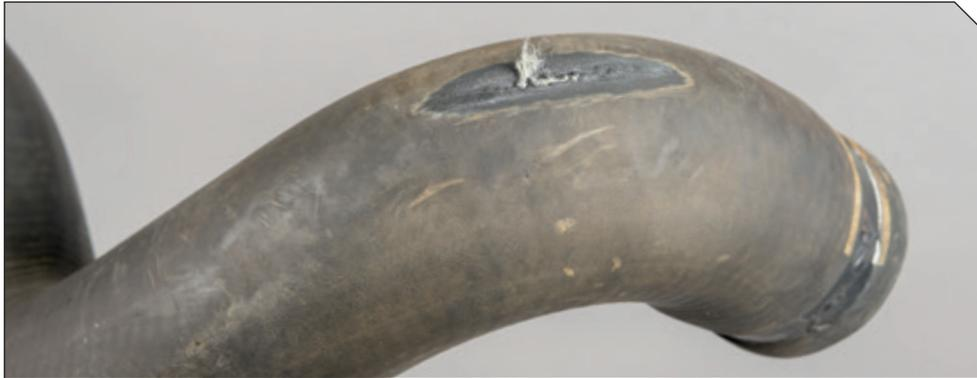
**Aspetto:** l'abrasione può essere individuata dai segni di sfregamento o dai danni sulla copertura del tubo.
