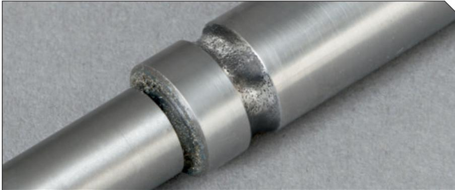
**Aspetto:** l'albero è piegato o, in alcuni casi, persino rotto. Una netta frattura che attraversa la ralla frontale del cuscinetto nell'albero indica che la pompa dell'acqua è stata soggetta a un improvviso sovraccarico o squilibrio dovuto a pesanti vibrazioni. Se l'albero rotto è scolorito (di solito blu), il danno è stato graduale a dimostrazione di un eccessivo accumulo di calore prima della rottura dell'albero stesso.
