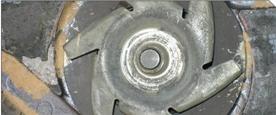
**Aspetto:** sedimenti, poltiglia e incrostazioni si accumulano all'interno, intasando la pompa dell'acqua e ostacolando il corretto funzionamento delle singole parti che la compongono.
