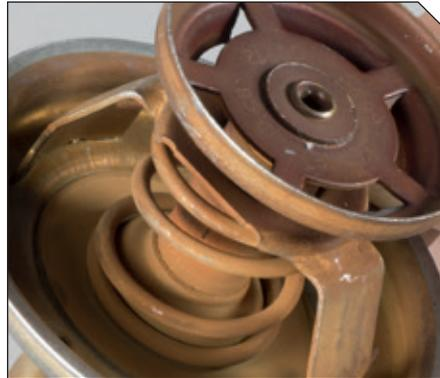
**Aspetto:** ruggine e corrosione sulle superfici del termostato. Le reazioni chimiche erodono il termostato lasciando piccoli fori e/o creando particelle che fungono da agenti abrasivi nel circuito di raffreddamento (in particolare nei punti in cui il flusso viene deviato e nei condotti più stretti), distruggendo i singoli componenti del termostato.
